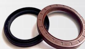
**Semerinzi (uljne brtve) - NBR, VITON i SILIKON** namijenjeni su brtvljenju otvora između rotirajuće i statične komponente ili između komponenata koje su u međusobnom kretanju. Služe za zadržavanje maziva, za zaštitu od prljavštine, za odvajanje tekućine ili plinova te podnošenje razlika u pritisku.
