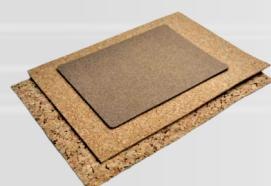
**Gumirani pluto** koji se odlikuje dobrom savitljivošću i elastičnošću. Većina tipova posjeduju dobru otpornost u dodiru s tekućim gorivima, uljima, vodom, plinovima i masnoćama. Mogu se naručiti u debljinama od 2 mm do 5 mm.
