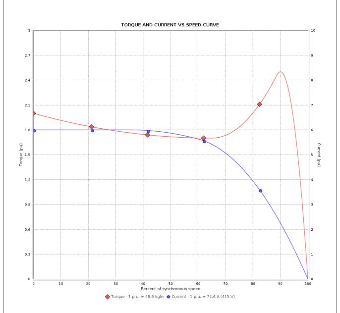
Performance : 415 V 50 Hz 8P Rated current : 74.6 A Moment of inertia (J) : 2.82 kgm<sup>2</sup> LRC : 6.0 Duty cycle : S1 Rated torque : 48.6 kgfm Insulation class : F : 200 % Service factor Locked rotor torque : 1.00 : 80 K Breakdown torque : 250 % Temperature rise
