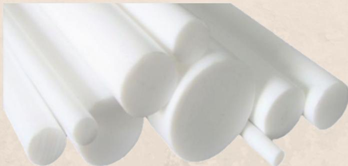
**Poliacetal je vrsta tehničke plastike koja odlikuje visokom čvrstinom i žilavosti. Otporna je na istezanje i izdržljiva pri visokim i niskim temperaturama. Otporan je na vlagu i kemikalije. Poliacetal spada u najčvršće i najtvrdje plastične materijale koji imaju visoki vijek korištenja. Koristi se za izradu prijenosnika, poluga, opruga, sklopki, za dijelove pumpe,...**
